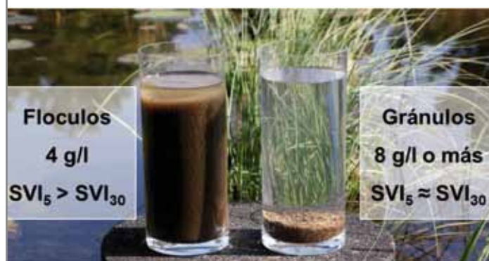
Figura 2. Propiedades de sedimentación de la biomasa granular aerobia (derecha) comparado con el fango activado (izquierda).
