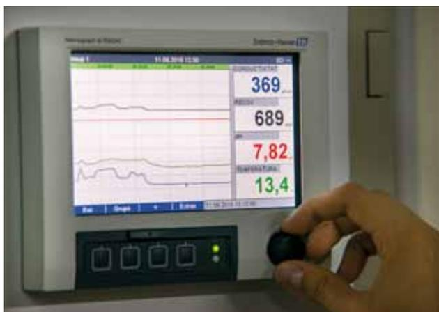
**FIGURA 7.** Analizador *in situ* de cloro libre y cloro total.
