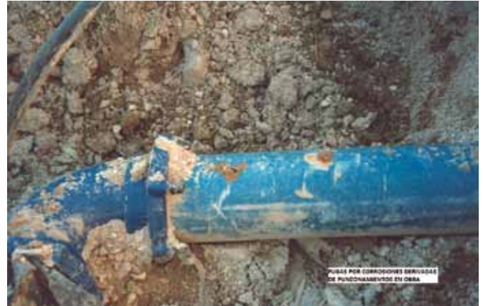
FIGURA 5. Fugas por corrosiones derivadas de malas actuaciones en las manipulaciones en obra. Por afecciones de máquina excavadora (izquierda) y por punzonamientos (derecha).
