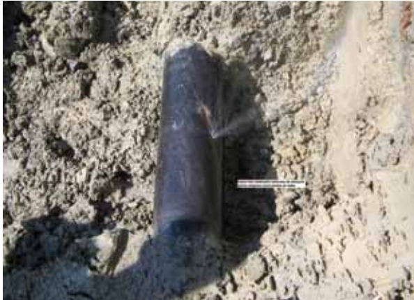
FIGURA 5. Fugas por corrosiones derivadas de malas actuaciones en las manipulaciones en obra. Por afecciones de máquina excavadora (izquierda) y por punzonamientos (derecha).
