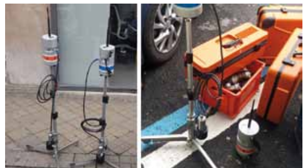
FIGURA 7. Correladores. Sistemas portátiles de captación y registro para determinar dónde está la fuga entre puntos de situación de los elementos en la zona indicada por el SCADA.
