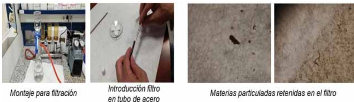
FIGURA 5. Proceso de análisis de microplásticos vía degradación térmica.
