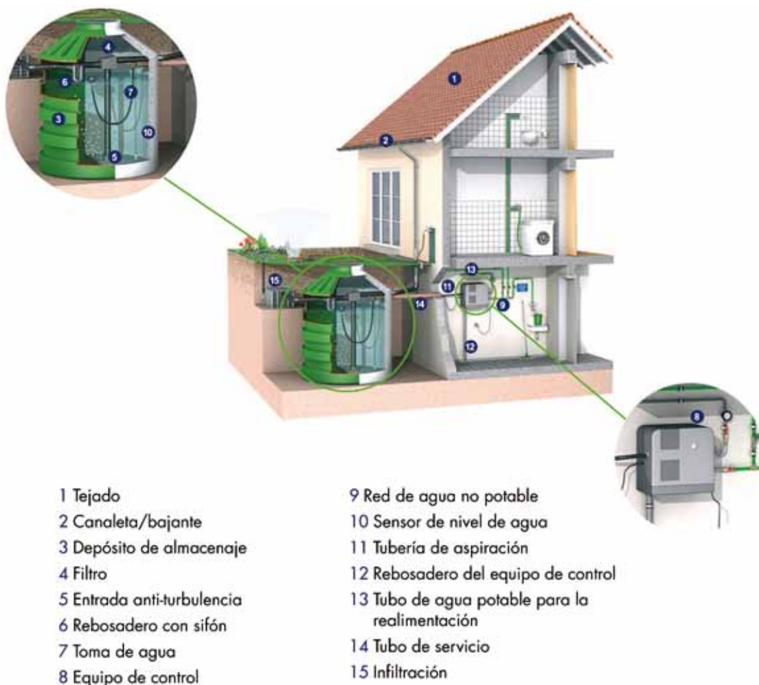
FIGURA 5. Componentes de la instalación para la recuperación de aguas pluviales.
