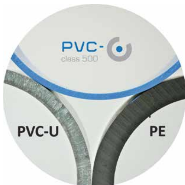
FIGURA 1. Detalle de espesores de diferentes materiales.
