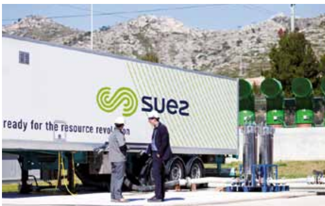
FIGURA 2. Solución de Suez a las exigencias de Dow: unidad móvil de ósmosis inversa con capacidad para 25 m 3 /h de agua.
