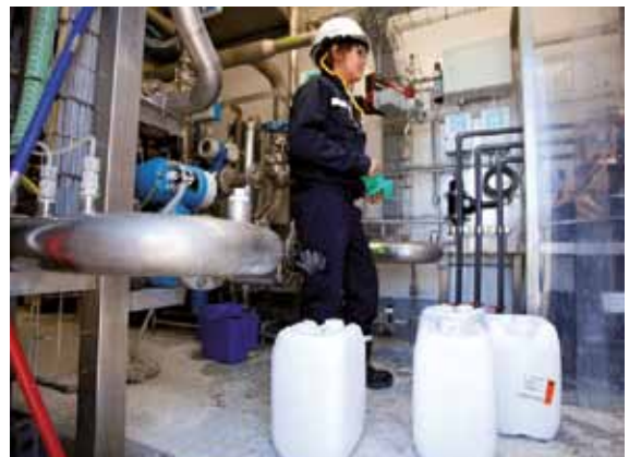
FIGURA 2. Solución de Suez a las exigencias de Dow: unidad móvil de ósmosis inversa con capacidad para 25 m 3 /h de agua.
