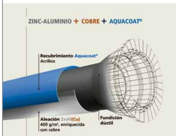
Figura 1. Composición del revestimiento BioZinalium.
