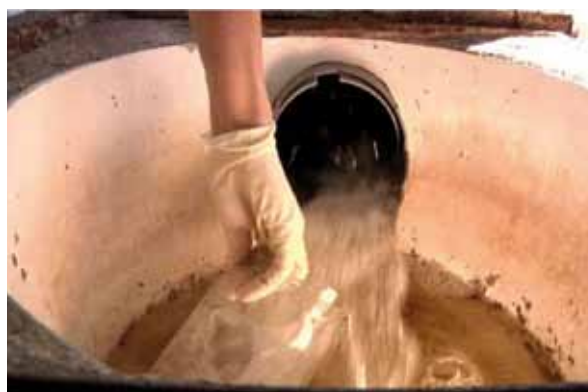
FIGURA 2. En la toma de muestras solo se debe recoger el agua que sale de la depuradora.
