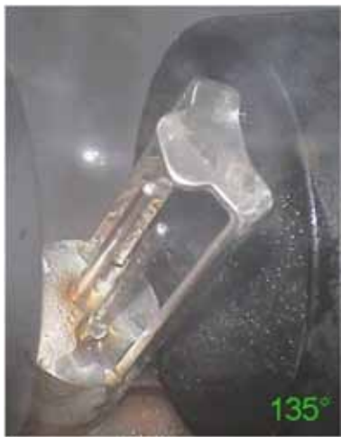
Figura 2. Influencia a las condensaciones instalando el t-mass 65 en diferentes posiciones. La mejor posición se consigue en la posición horaria de las 5.
