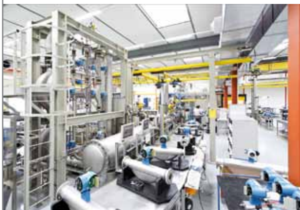
Figura 5. PremiumCal, preciso banco de calibración (+/-0,015%) donde se calibran los caudalímetros coriolis.
