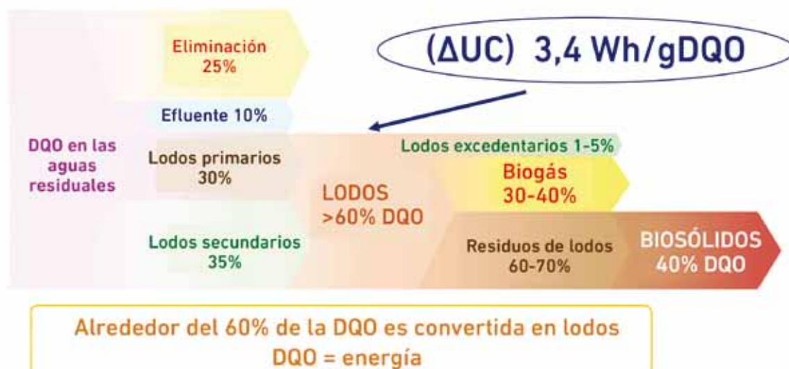
Figura 1. Balance energético en una EDAR con lodos activos y digestión anaeróbica.
