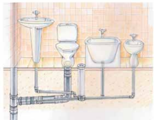
Figura 2. Desagüe de aparatos sanitarios con bote sifónico.
