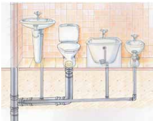
Figura 1. Desagüe de aparatos sanitarios con sifón individual.
