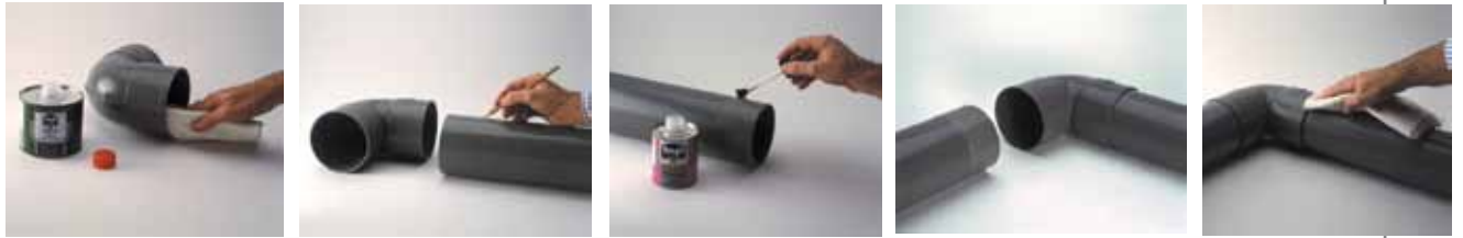
Figura 5. Proceso de unión de tuberías mediante el sistema de encolado.
