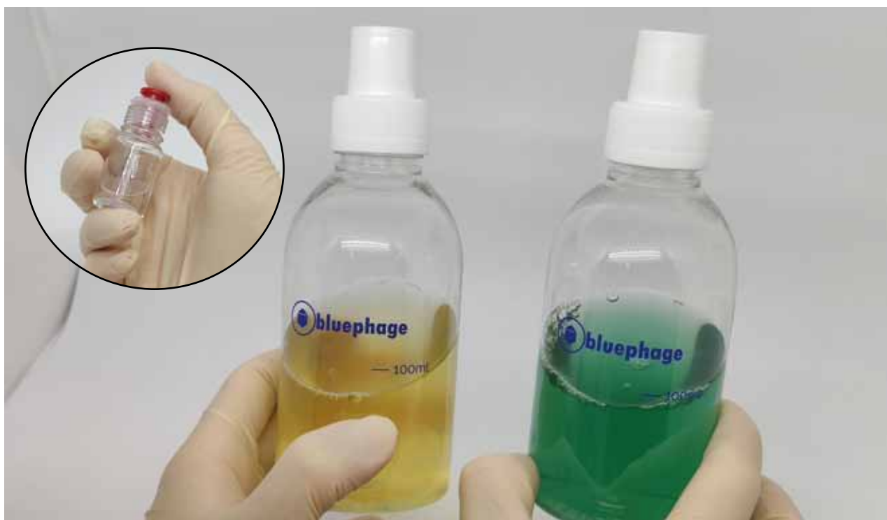
FIGURA 3. Muestras de agua analizadas con el método Bluephage. Izquierda, control negativo (ausencia de colifagos); y derecha, muestra de agua positiva (presencia de colifagos).
