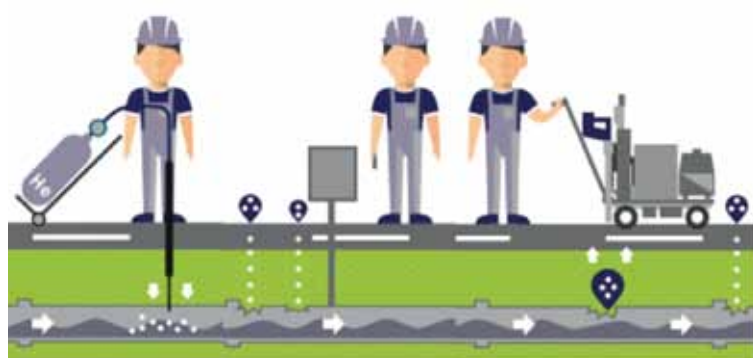
FIGURA 7. Sistema Idroloc de localización de fugas con gas trazador helio.
