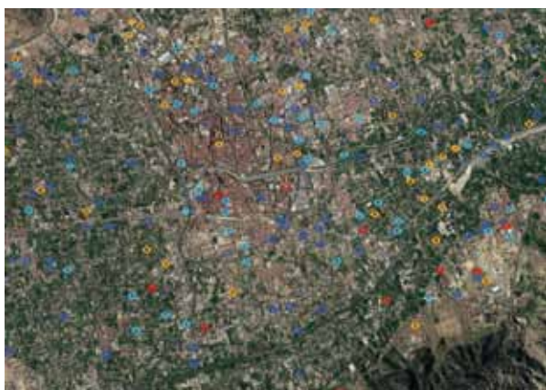
FIGURA 6. Prelocalización de fugas mediante satélite.
