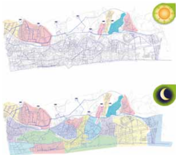
FIGURA 4. Imagen superior: red de distribución con 7 sectores clásicos durante el día; imagen inferior: red de distribución con 18 microsectores dinámicos durante la noche.
