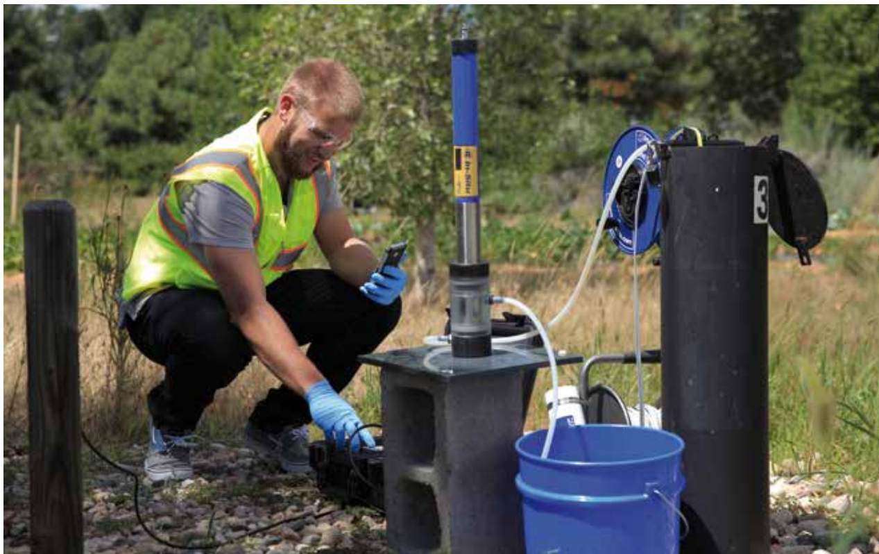
FIGURA 2. Aquatroll 600: Sonda multiparamétrica para la monitorización de nivel y calidad del agua en sondeos.
