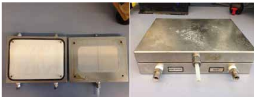
FIGURA 2. Módulo para filtración por membranas planas a escala laboratorio.
