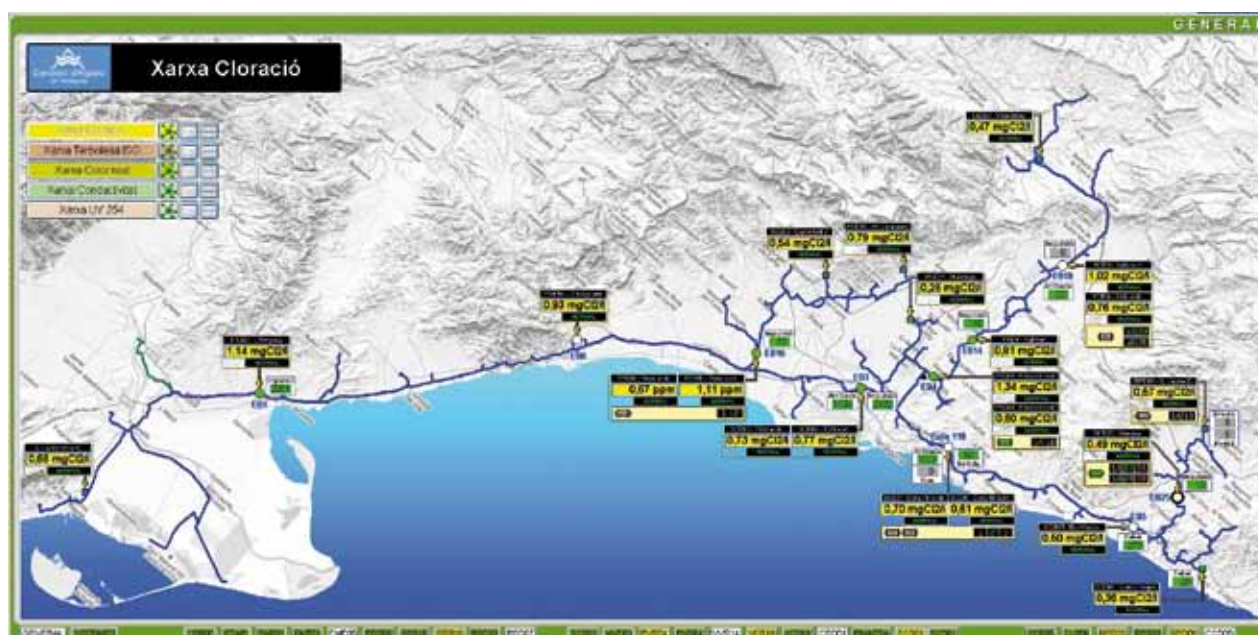
FIGURA 8. SCADA de calidad del agua del CAT: cloro libre.
