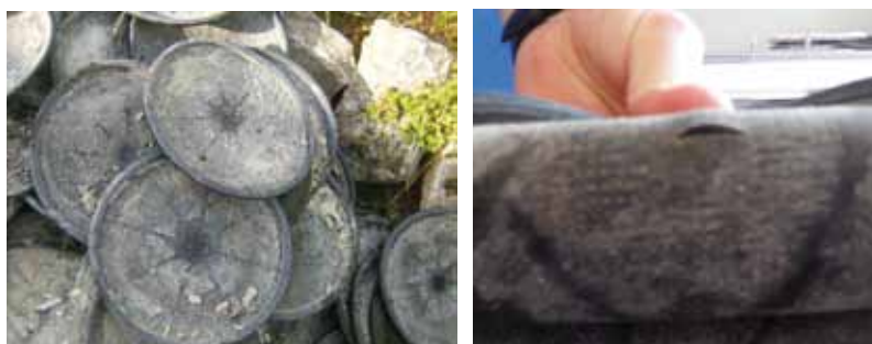
Figura 6. Depositiones calcáreas en la membrana (imagen izquierda) y rotura de la membrana por incrustaciones (derecha).
