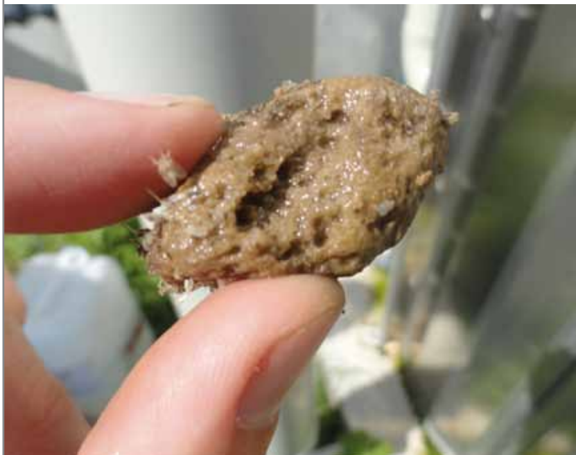
Figura 6. Partícula de relleno con biopelícula de una instalación similar.
