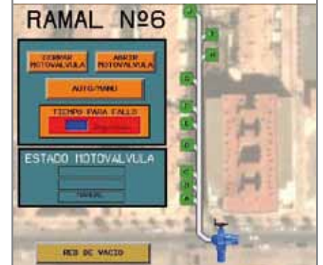
Figura 6. Pantalla de control de un ramal. Las válvulas de vacío aparecen como círculos verdes.
