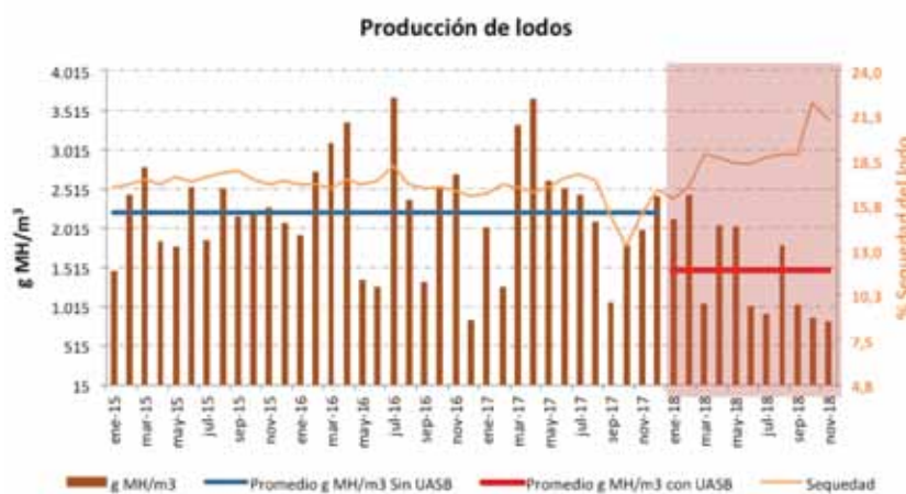
FIGURA 8. Evolución de la producción de lodos y sequedad en la EDAR de 2015 a 2018.
