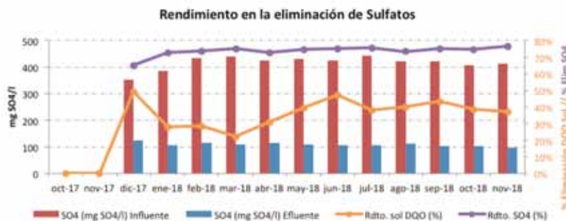
FIGURA 6. Evolución del rendimiento de eliminación de sulfatos y DQO en el tratamiento anaerobio.
