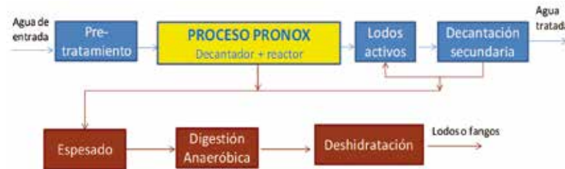
FIGURA 2. Esquema conceptual del proceso Pronox.
