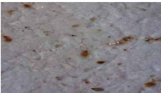
FIGURA 8. Visualización general de la superficie de un filtro de SDI de 0,45 \mu m a la salida de los filtros de arena, con magnificación de 40x. Gentileza de Facet Ibérica.
