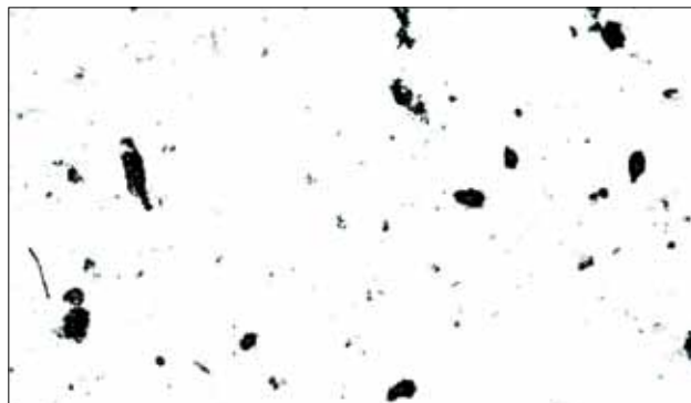
FIGURA 9. Foto originada por el software de conteo de los datos obtenidos a la salida de los filtros de arena. Gentileza de Facet Ibérica.
