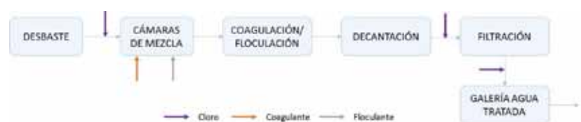
FIGURA 1. Esquema de la ETAP convencional de Sagunto (Valencia).
