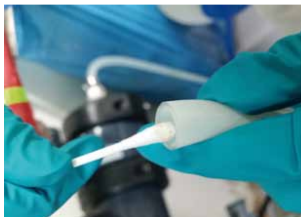
FIGURA 2. Muestreo de la superficie interior del tubo de salida del sistema DSS.
