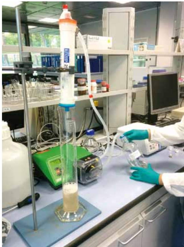
FIGURA 1. Elución del filtro Rexeed en los laboratorios de Aigües de Barcelona. Fuente: Aigües de Barcelona.
