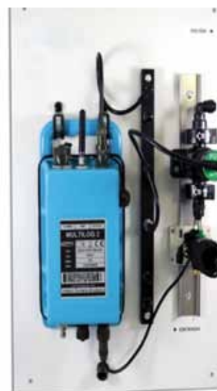
FIGURA 10. VRP con picoturbina y modulo con sensores para medición de la calidad de agua.
