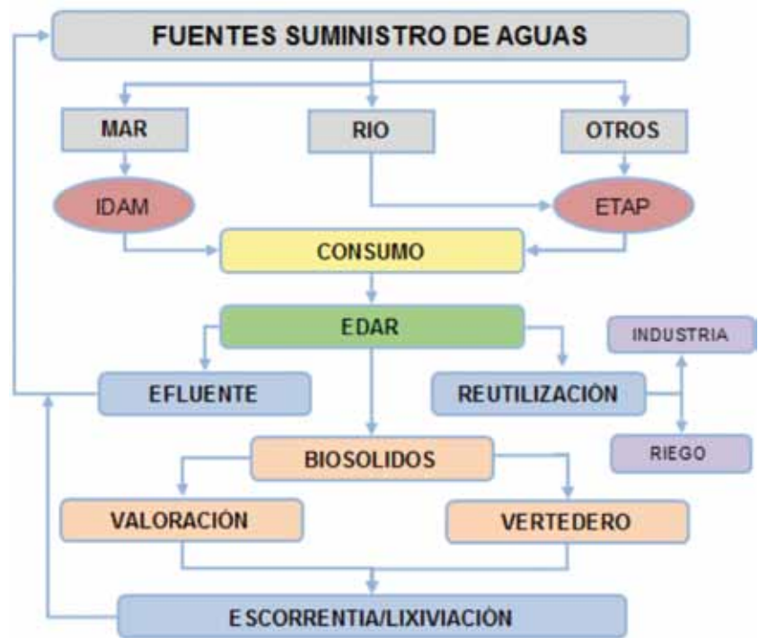
FIGURA 1. Vías de entrada de los contaminantes emergentes. Notas: IDAM, instalación desaladora de agua de mar; ETAP, estación de tratamiento de agua potable; EDAR, estación depuradora de aguas residuales [1].
