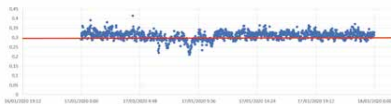
FIGURA 9. Altura del manto de fangos medido en la periferia del decantador correspondiente a 3 días.
