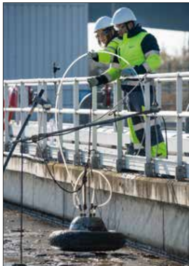
FIGURA 2. A la izquierda, campana de medición de óxido nitroso ( N_2O ) en fase gas. A la derecha, analizador de gases Horiba.
