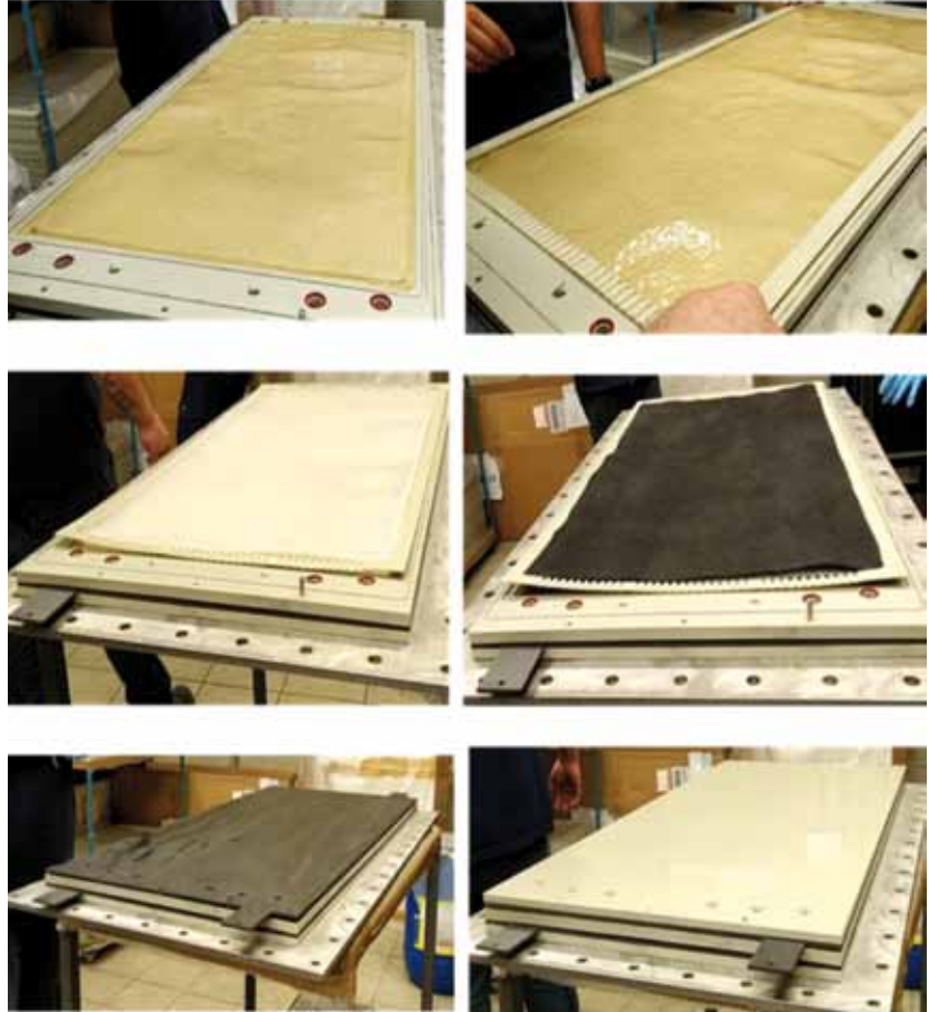
FIGURA 4. Imagen de alguno de los componentes de la MDC piloto. De izquierda a derecha empezando por arriba: membrana de intercambio catiónico, marco catódico, distribuidor de flujo catódico, espuma de carbón, colector de corriente catódico y placa final aislante.
