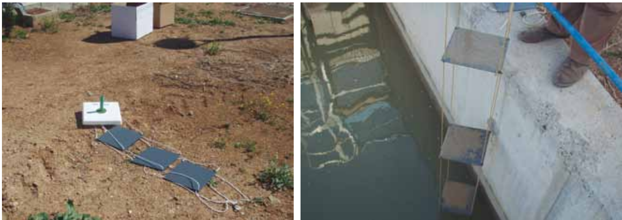
FIGURA 4. Placas de PVC colocadas en la arqueta del Sector IX para la realización del seguimiento.
