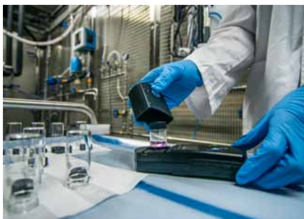
FIGURA 7. Analizador in situ de cloro libre y cloro total. Fuente: Cetaqua.
