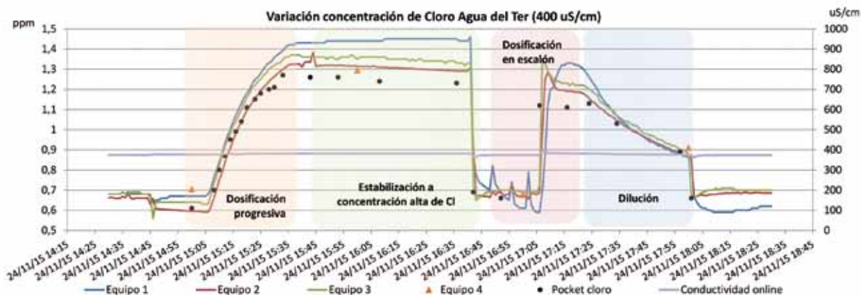
FIGURA 9. Prueba de validación de los sensores de cloro: variación de la concentración de cloro. Fuente: Cetaqua.
