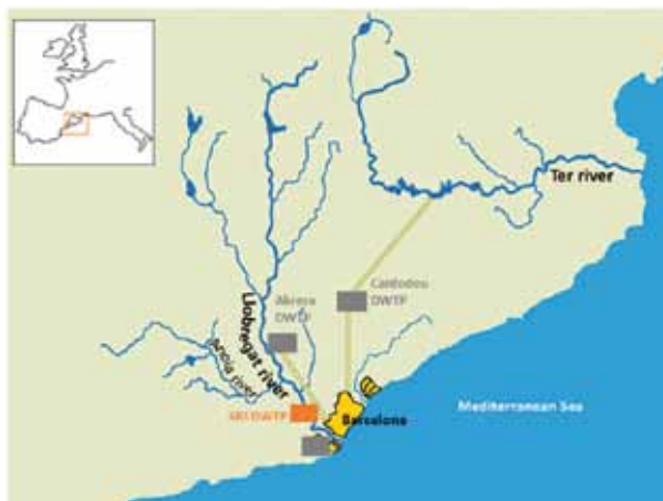
FIGURA 1. Sistema Ter-Llobregat y sus principales contribuciones en la distribución de agua potable en Barcelona. Fuente: Aguas de Barcelona.
