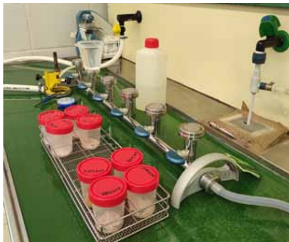
FIGURA 3. Análisis en el Laboratorio Municipal de Vitoria-Gasteiz según el procedimiento de ISO 11731.
