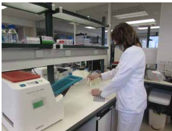
FIGURA 2. Análisis de muestras en el laboratorio de Amvisa mediante Legiolert de Idexx.
