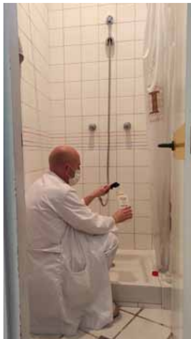
FIGURA 1. Recogida de muestras en una instalación interior de Vitoria.
