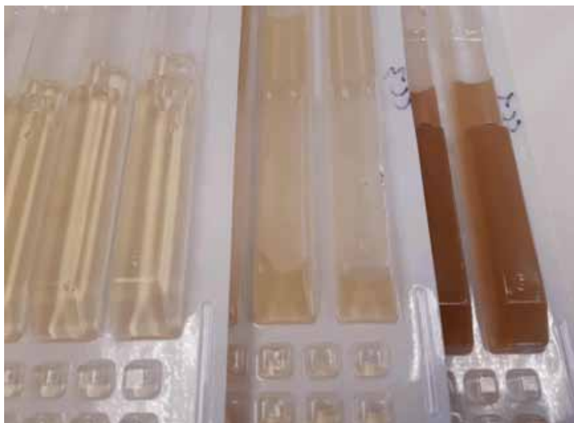
FIGURA 4. Comparación de turbidez en las muestras: blanco (muestra de la izquierda); positivo con turbidez sin pigmentación (muestra del centro); y positivo con pigmentación (muestra de la derecha).
