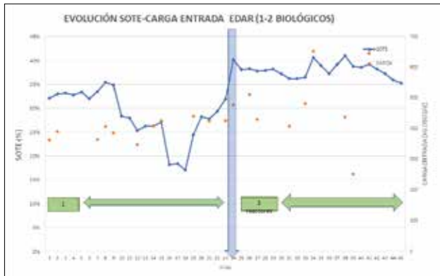
FIGURA 12. Evolución del balance de la aireación al trabajar con 1 o 2 reactores biológicos.
