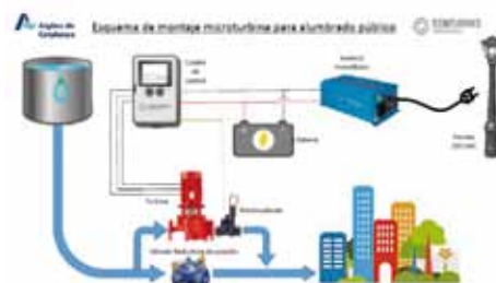
FIGURA 8. Esquema del uso la energía de una turbina para alumbrado público.
