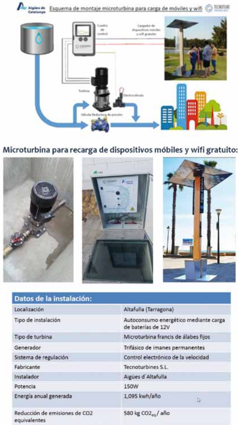
FIGURA 7. Esquemas, fotografías y datos del proyecto de microturbina en Altafulla (Tarragona).
