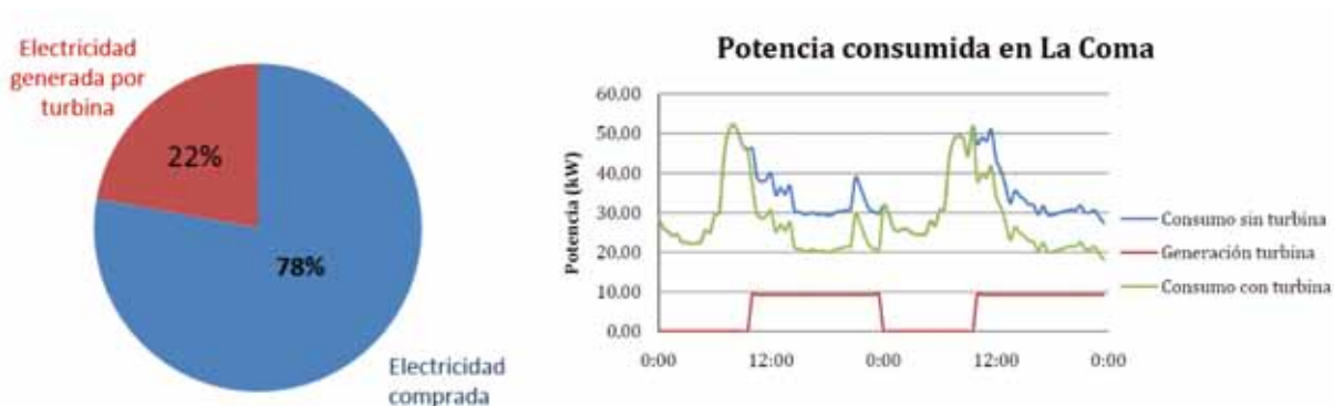
FIGURA 11. Energía producida por la microturbina de La Coma.
