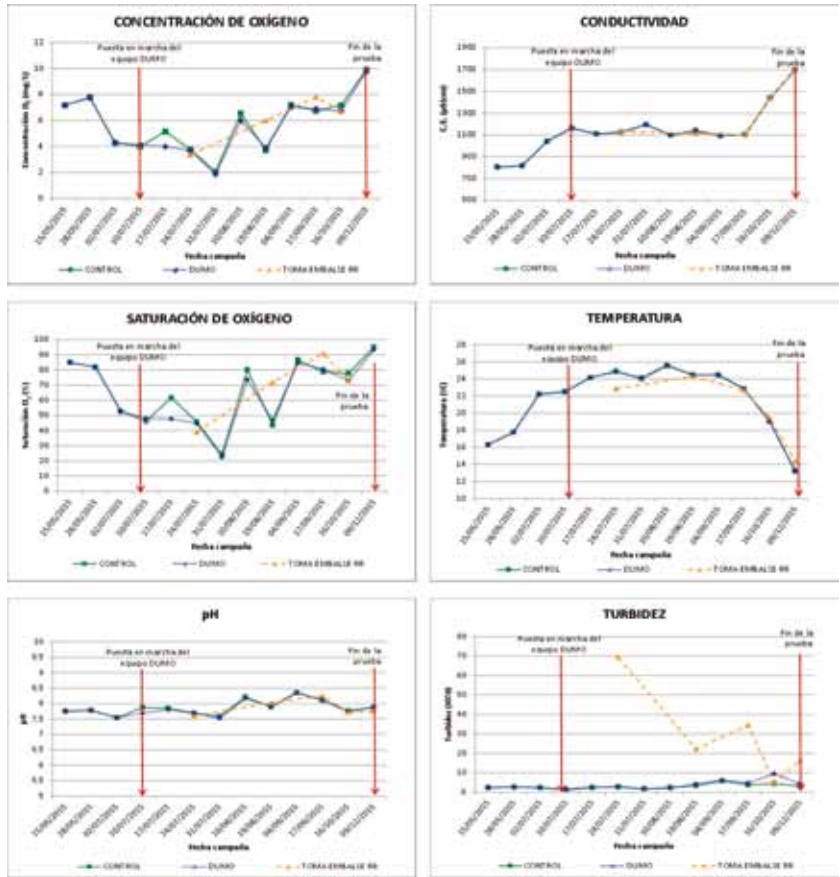
FIGURA 5. Evolución de los diferentes parámetros fisicoquímicos durante la realización del seguimiento, en el canal de control, en el canal con tratamiento ultrasónico y en la toma embalse de Riba-roja: concentración de oxígeno, conductividad, saturación de oxígeno, temperatura, pH y turbidez, respectivamente.
