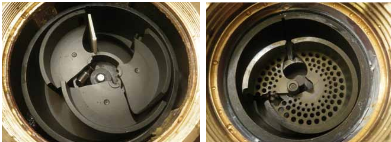
FIGURA 4. Rotura del pistón rotativo en contadores volumétricos.
